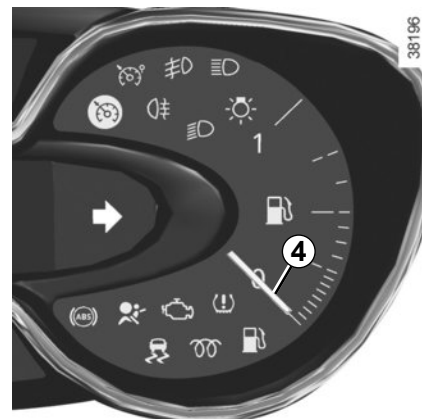
Az alacsony motorolajszintre figyelmeztető jelzés
